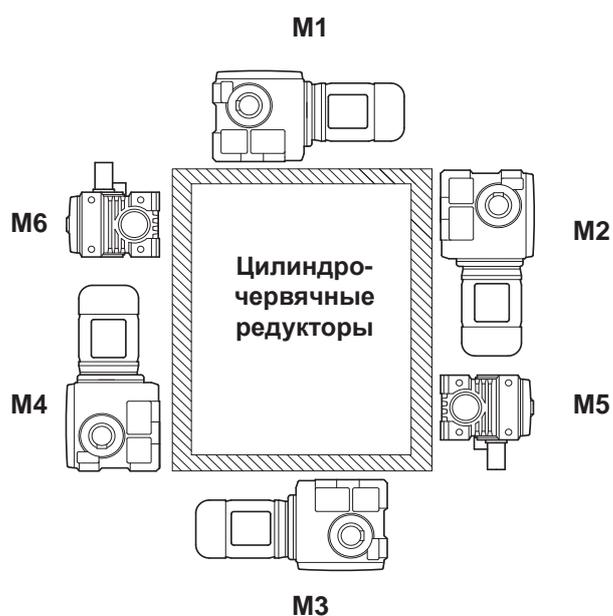
Монтажные положения с расположением пробки маслоналивного отверстия, воздушного клапана и слива масла Вы найдете на странице A53 и далее.
