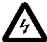
Опасность поражения электрическим током или высоким напряжением!
